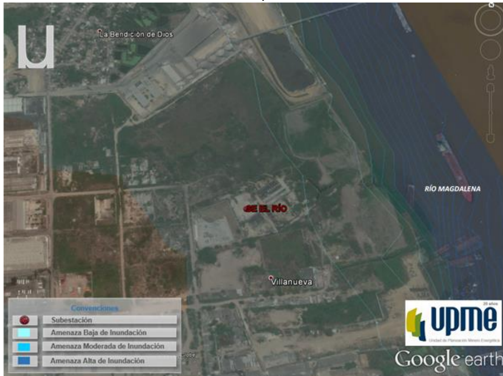
Gráfica 6-120: Amenaza de Inundación en predios de la Subestación El Río 110 kV.
