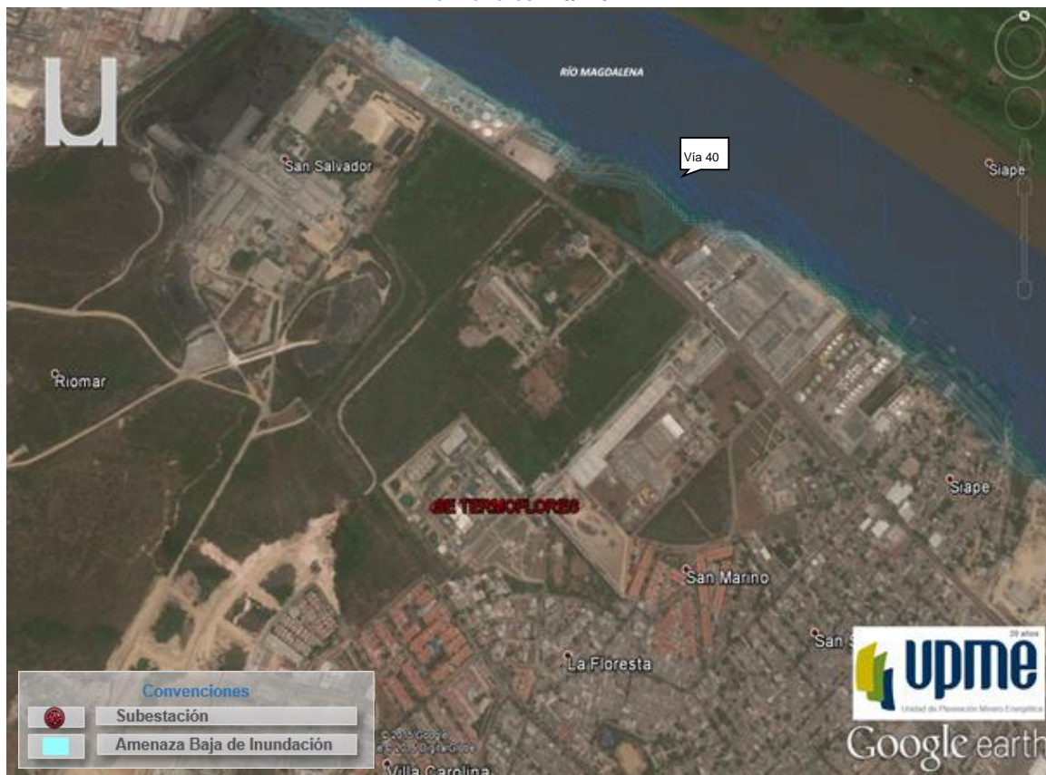
Gráfica 6-116: Amenaza de Inundación Baja en predios cercanos al Río Magdalena, en inmediaciones de la Subestación Termoflores 220/110 kV.
