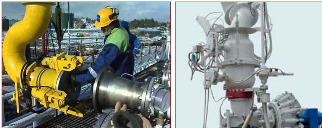
Figura: Acoplamiento con QCDC de brazo de descarga de GNL (izda.) y sistema ERS (dcha.)
