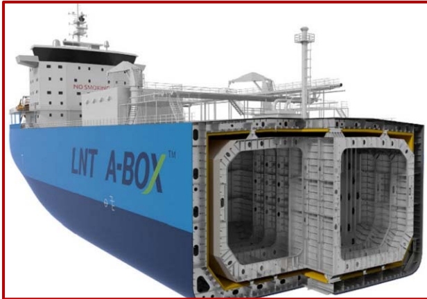
Configuración tanques prismáticos. Tipo Membrana
