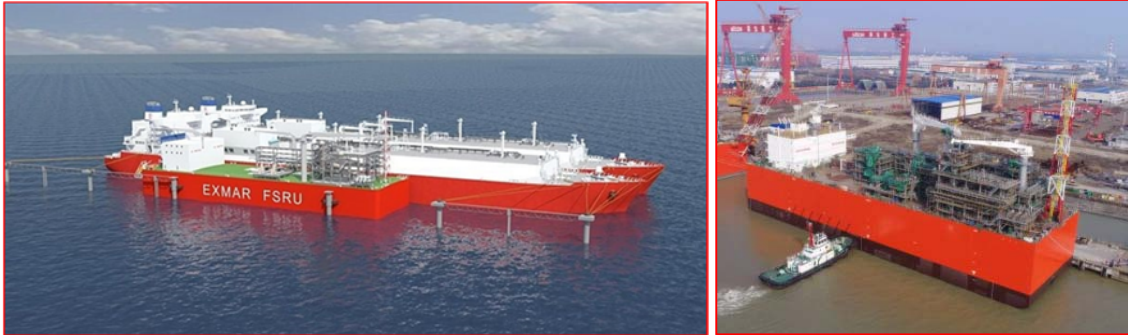
Figura: Barcaza de regasificación offshore Exmar FSRU
