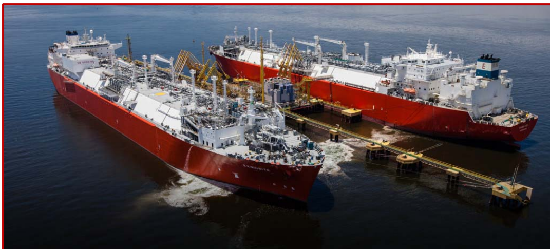
Trasvase de GNL entre buque carrier y FSRU por medio de brazos articulados
