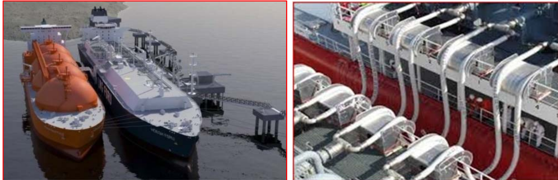
Figura: Descarga ship-to ship. Transferencia de GNL con mangueras criogénicas.
