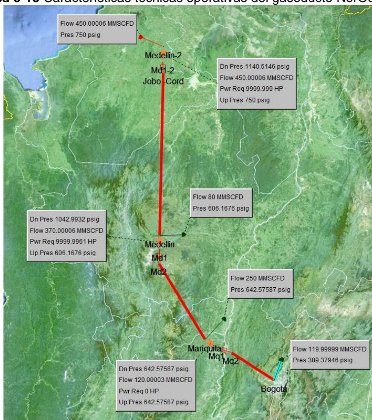
Gráfica 8-15 Características técnicas operativas del gasoducto NorOccidente
