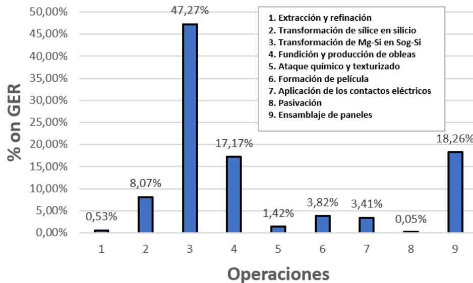
Figura 11. Requisitos de energía para fabricación de paneles fotovoltaicos vs porcentaje de energía bruta [20].
