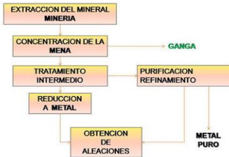
Figura 46. Fases del proceso metalúrgico.
