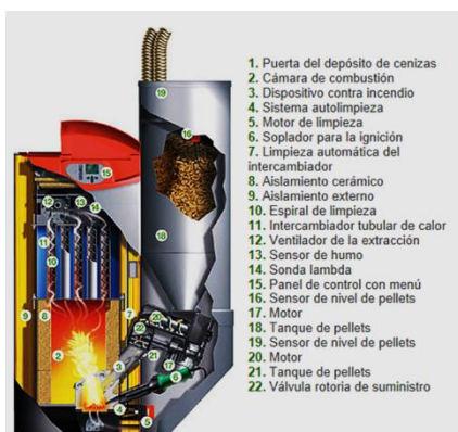
Figura 29. Caldera de Biomasa (Pellets)
