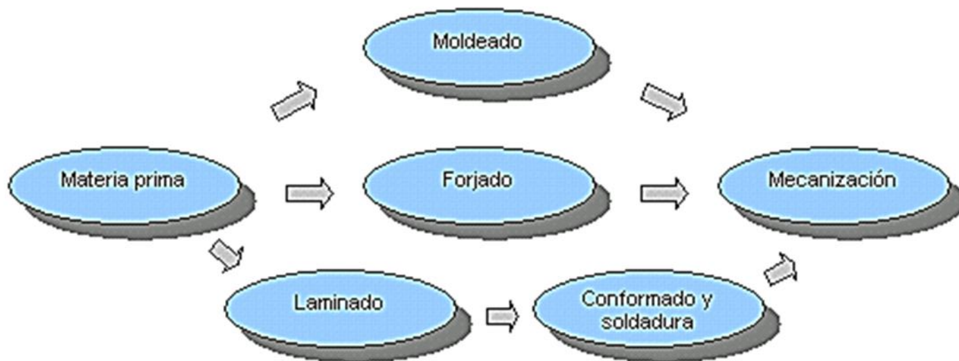
Figura 19. Diagrama de proceso del CIU 2511 Fabricación de productos metálicos para uso estructural
