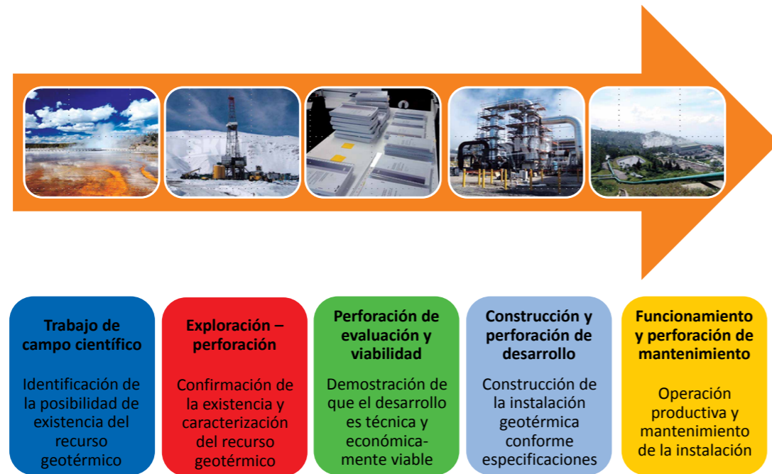
Figura A4.1. Fases del desarrollo de un proyecto geotérmico. Fuente: Adaptada de IGA, 2013.
