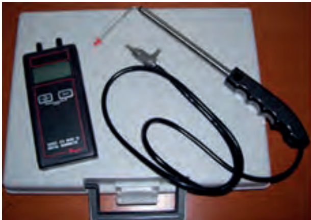
Figura 39: Tubos de Pitot (y manómetro digital) usados en las evaluaciones de los sistemas de vapor
