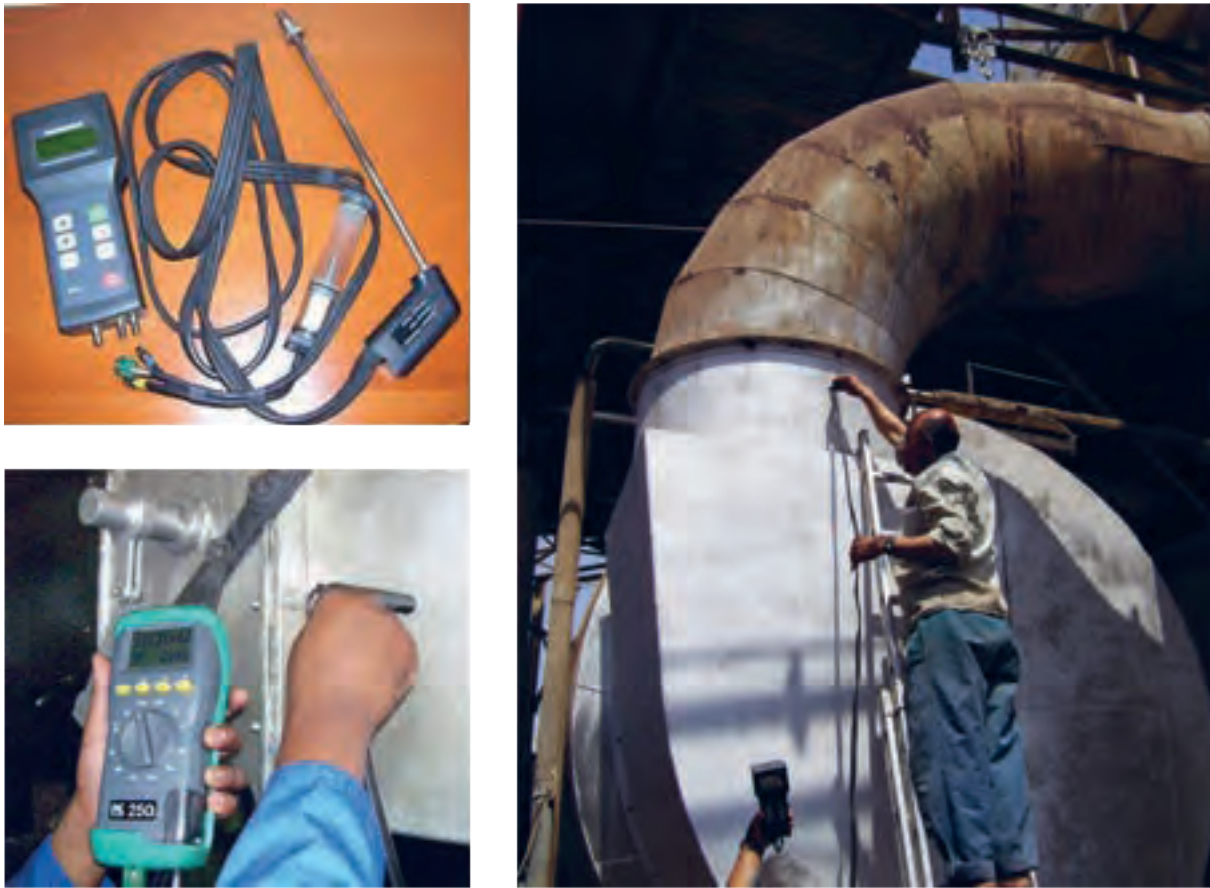
Figura 40: Uso de los analizadores de gases en las evaluaciones de los sistemas de vapor
