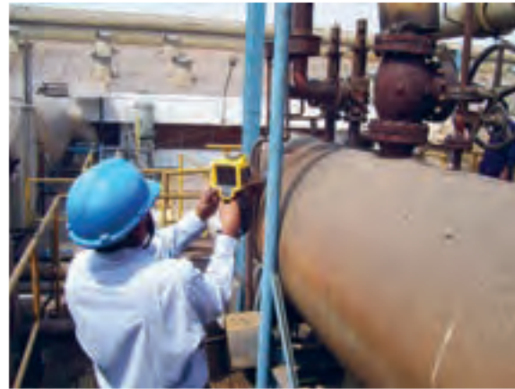
Figura 38: Imágenes tomadas por una cámara termográfica durante una evaluación de un sistema de vapor
