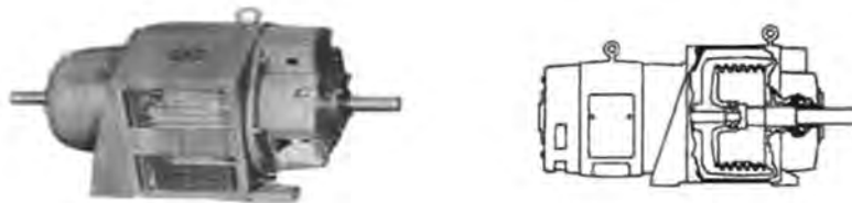
Figura 9.15 Dispositivo con embrague magnético por corrientes de Foucault
