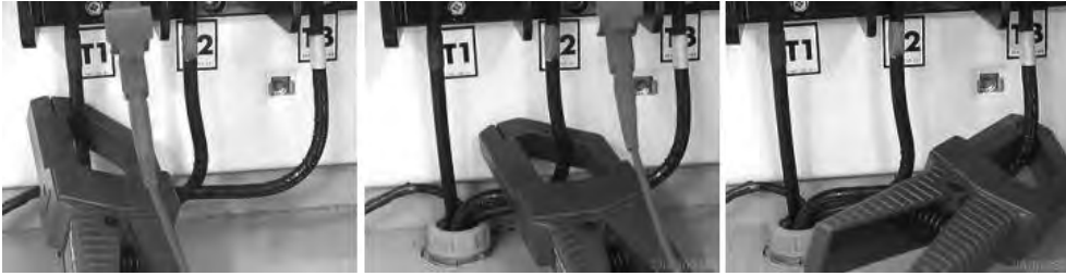
Figura 12.29 Mediciones de la corriente de cada fase
