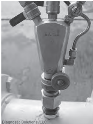
Figura 12.21 Medición del caudal con un tubo de Pitot multipuerto
