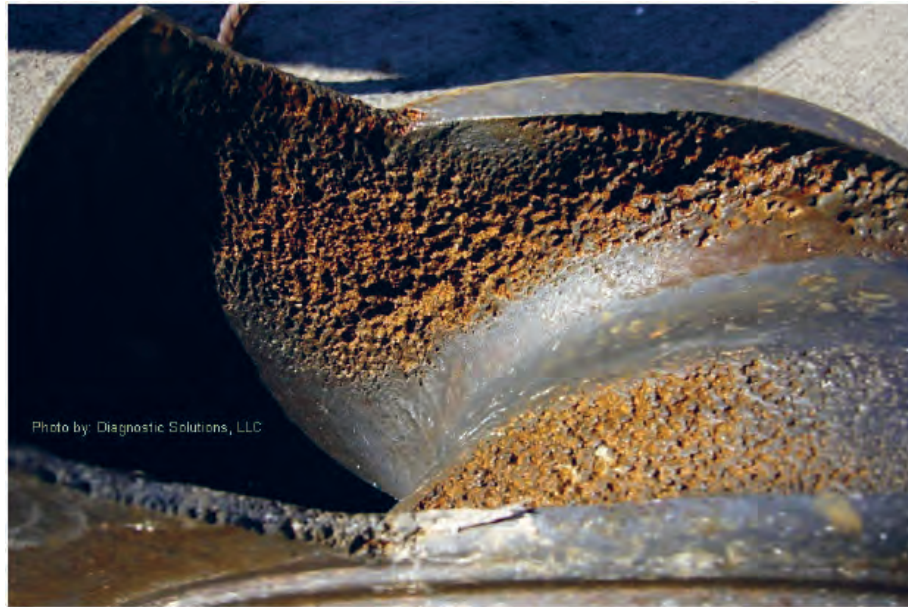
Figura 5.10 Daños por cavitación en un impulsor
