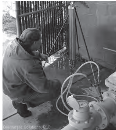
Figura 12.21 Medición del caudal con un tubo de Pitot multipuerto
