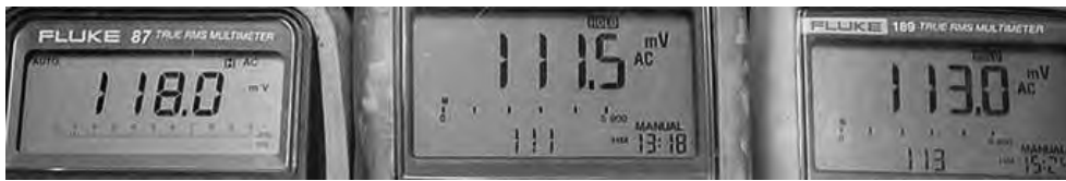
Figura 12.29 Mediciones de la corriente de cada fase
