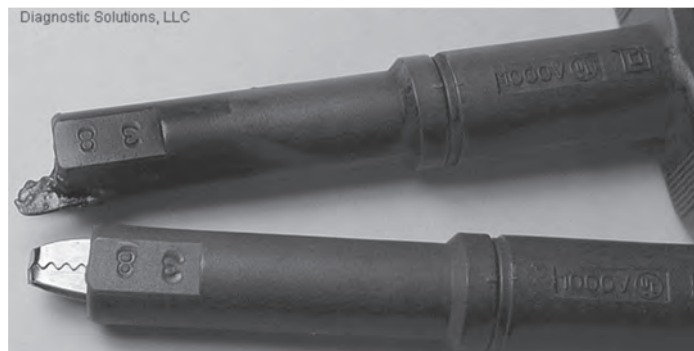
Figura 12.25 Cables de prueba (normal y fundido)
