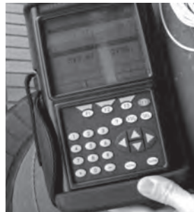
Figura 12.22 Caudalímetro ultrasónico de tiempo de tránsito
