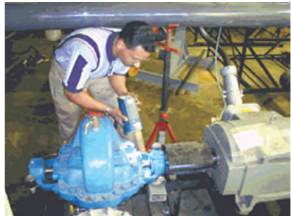
Figura 12.30 Medición de las rpm
