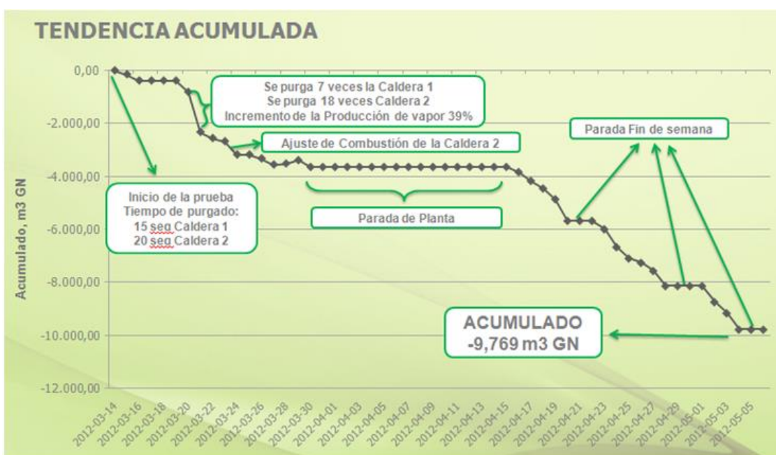
Ilustración 32. Ejemplo de mejora análisis de mejora del desempeño energético usando el indicador de tendencia de consumos
