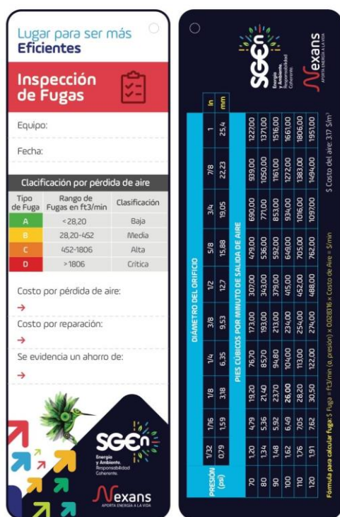
Ilustración 37. Ficha de identificación de fugas desarrollada en el marco del SGen
