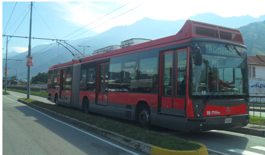
Fotografía 2-1. Concepto e-BRT con catenaria en Mérida, Venezuela (Velandia, 2012)
