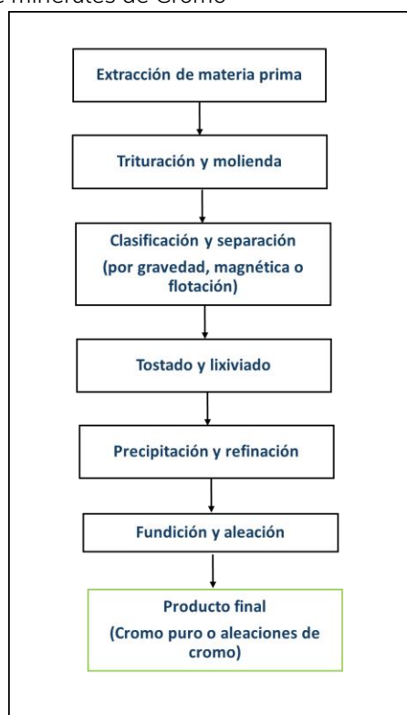
Figura 61. Proceso de beneficio de minerales de Cromo
