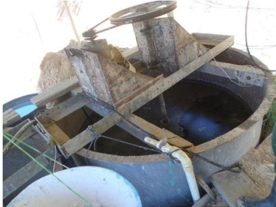
– **Tanque de cianuración (Agitación):** “En este tipo de operación la pulpa se mantiene en movimiento con el objetivo de acelerar el proceso de disolución y exposición de las partículas metálicas a la acción del agente disolvente. Suele ser proceso continuo donde carga nuevo material mientras se recoge el ya procesado. El proceso suele durar alrededor de 18 horas. Sin embargo, conforme la relación costo beneficio de cada operación este tiempo
