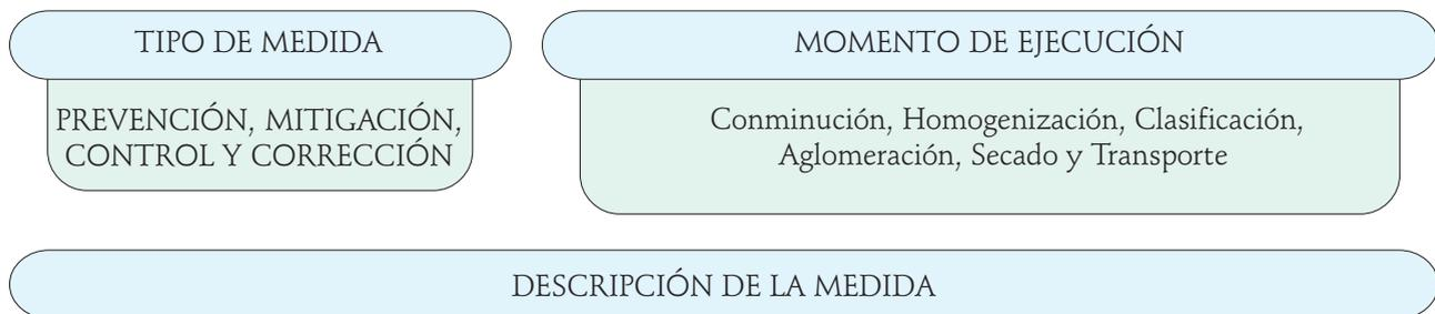
Para el manejo de ruidos provenientes de las plantas de Beneficio y Transformación de Minerales se busca su reducción en la fuente (rediseño o reemplazo), la modificación de la ruta de propagación (uso de encerramiento, pantallas, etc.) o el aislamiento del receptor. Generalmente, la reducción de la fuente de ruido es el método más usado y más efectivo de los tres.
