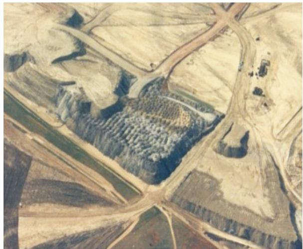
Foto. Disposición de estériles. Cortesía de CARBOCOL.
