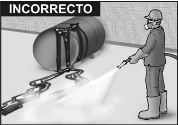
Figura 35. Manejo de derrames. Todos los derrames deben ser tratados inmediatamente. No se debe usar agua para drenar el material derramado. Se debe utilizar materiales absorbentes y recoger los residuos.
