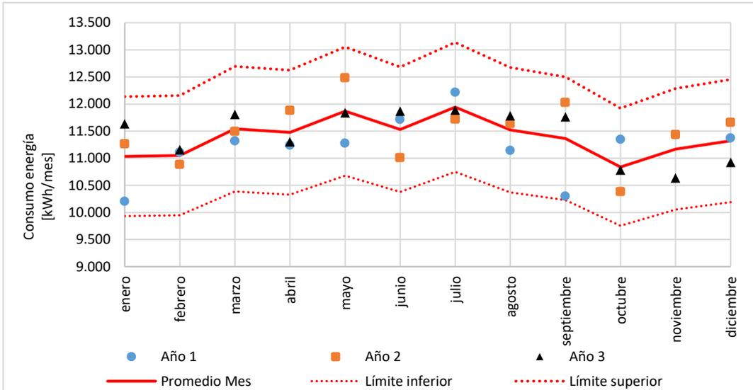
La verificación del modelo se hace a partir de la visualización de los datos del periodo base. Si los datos analizados se encuentran dentro del intervalo de confianza, los datos representan un dato significativo del consumo de la energía para cada mes. En este caso, cada uno de los tres puntos (año 1, año 2 y año 3) se encuentran dentro del límite de +/- 10% en el mes, por lo que los datos son representativos para la estimación del consumo.
