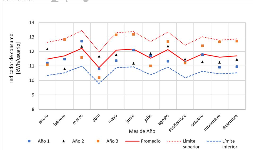
La verificación del modelo se hace a partir de la visualización de los datos del periodo base. Si los datos analizados se encuentran dentro del intervalo de confianza, los datos representan un dato significativo del consumo de la energía para cada mes. En este caso, cada uno de los tres puntos (año 1, año 2 y año 3) se encuentran dentro del límite de +/- 10% en el mes, por lo que los datos son representativos para la estimación del consumo.
