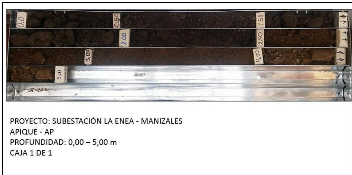
*Figura N° 9. Perfil estratigráfico del Apique con avance con barreno manual*
