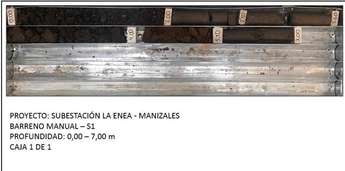
Figura N° 7. Perfil estratigráfico Barreno Manual - S1
