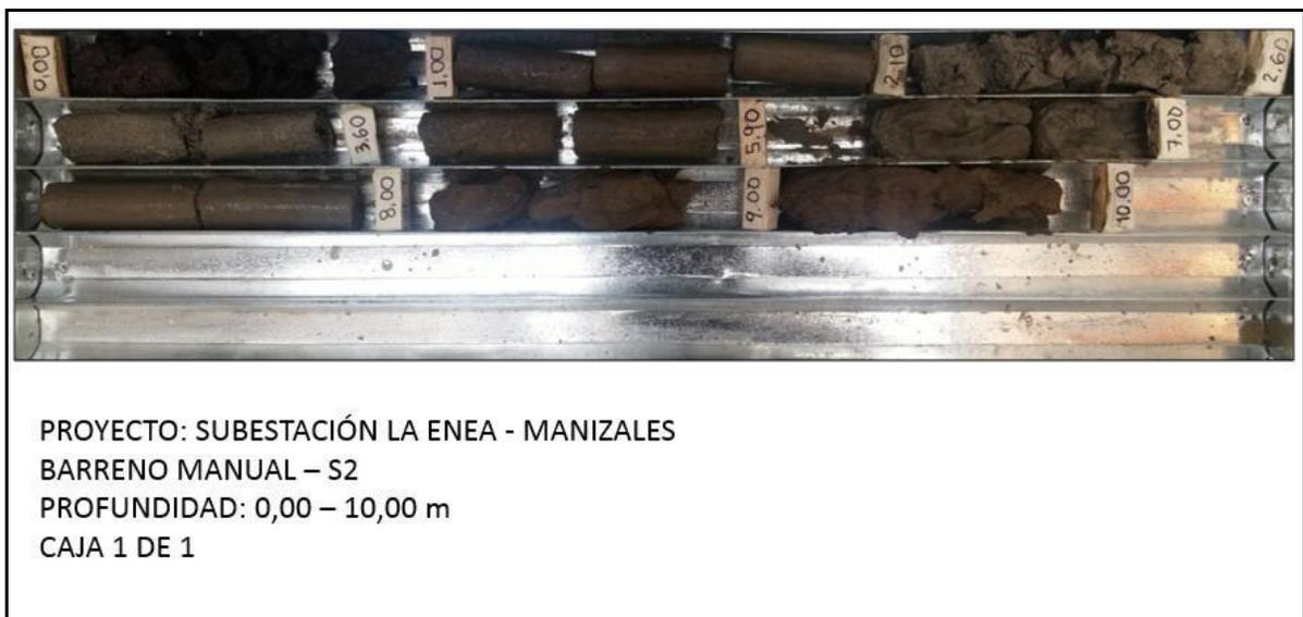
**Figura N° 10. Perfil estratigráfico Barreno Manual - S2**
