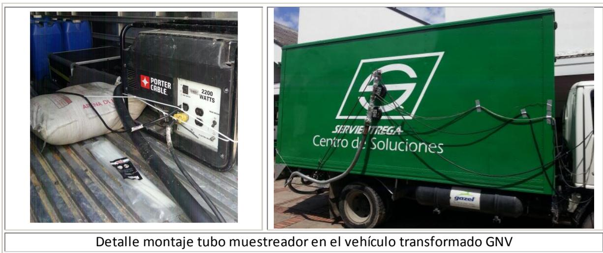
Detalle montaje tubo muestreador en el vehículo transformado GNV
