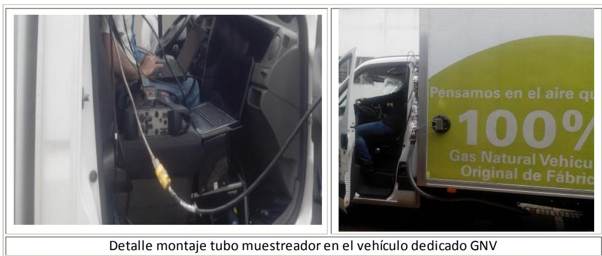
Detalle montaje tubo muestreador en el vehículo dedicado GNV
