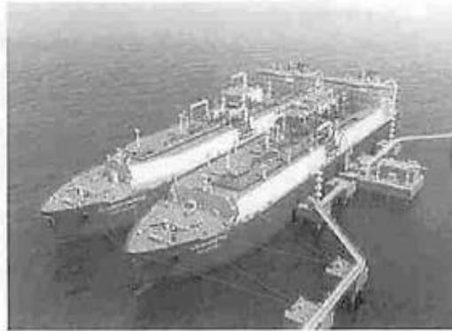
Si bien es cierto el transporte de GNL en un buque gasero es seguro al transportarse criogenizado a una temperatura de  $-161^{\circ}$  grados centígrados, si hay condiciones de seguridad náutica de mayor exigencia haciendo que existan áreas de restricción que pueden afectar a los terminales vecinos o a los canales de navegación.
