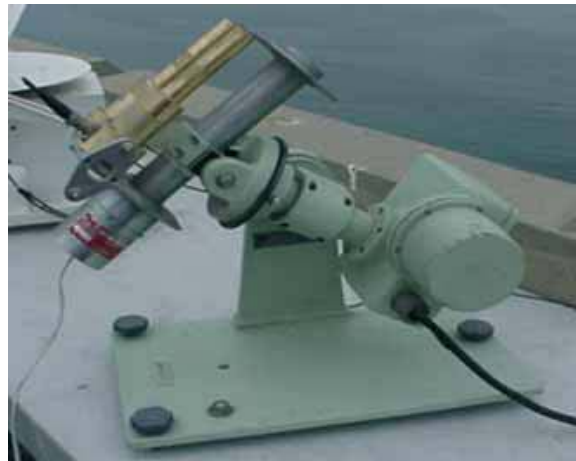
Figura 3.2. Pirheliómetro Eppley de incidencia normal (montado sobre un seguidor del Sol)
