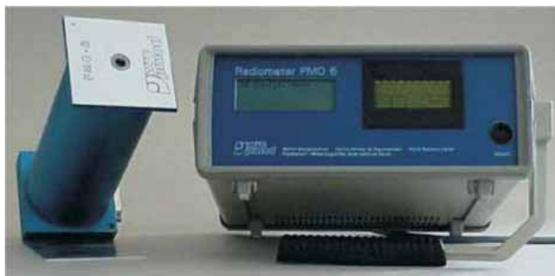
Figura 3.1. Pirheliómetro de cavidad absoluta PMO6
