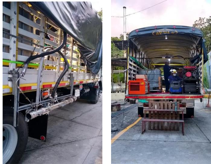
**Figura 2. 5.** Camión de prueba. Izq.: intervención del tubo de escape. Der.: con equipos de medición y carga simulada a bordo
