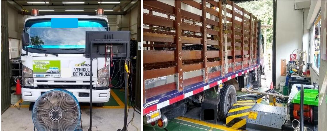
**Figura A. 1.** Vehículo de prueba en chasis dinamométrico
