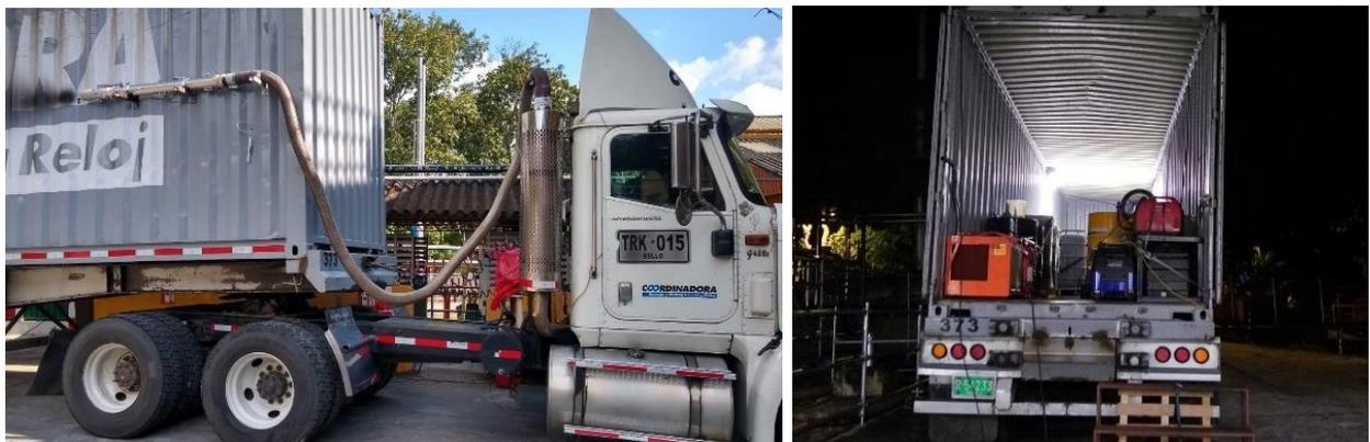
**Figura A. 2.** Adaptación del tubo de muestreo al tubo de escape (izquierda) y contenedor cargado (derecha).
