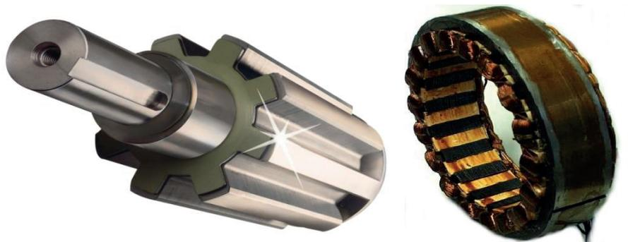
A diferencia de los motores de inducción, los motores de reluctancia conmutada requieren un circuito convertidor de potencia que controle las corrientes de fase para producir movimiento y par continuos. La información sobre la posición del rotor se usa para controlar la energización de la fase de manera óptima. Se puede variar la velocidad cambiando la frecuencia de los pulsos de la corriente de fase al mismo tiempo que se conserva el sincronismo con la posición del rotor.
