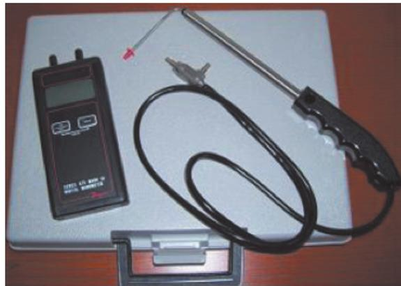
**Figura 30. Tubos de Pitot (y manómetro digital) usados en las evaluaciones de los sistemas de vapor.**
