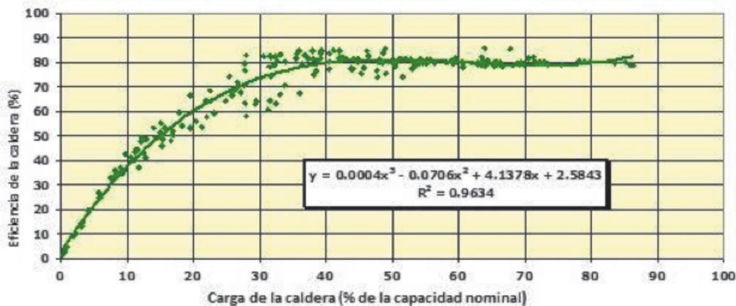
Figura 16. Curva típica de la eficiencia de las calderas de natural. Guía ONUDI
