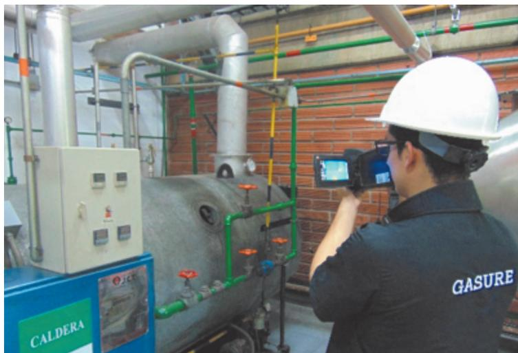
**Figura 27. Uso de una cámara termográfica en una evaluación de un sistema de vapor**
